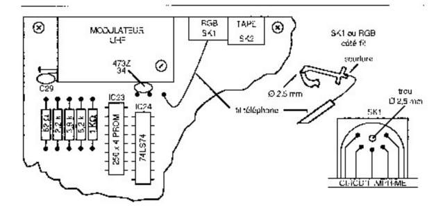
Par bonheur, il n'en allait pas de même du câble EUREKA. J'y découvris le montage suivant qui, réalisé avec 3 mètres de câble blindé 8
