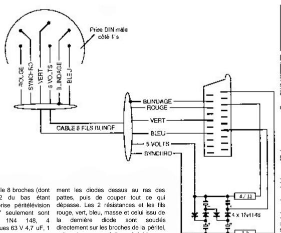
fils, une prise DIN mâle 8 broches (dont une centrale, les 2 du bas étant condamnées), une prise péritélévision mâle 20 broches (7 seulement sont 4 diodes 1N4 condensateurs chimiques 63 V 4,7 uF, 1 résistance céramique de 47  $\Omega$ , et une autre de  $1~\Omega$ , m'est revenu à une cinquantaine de francs.
